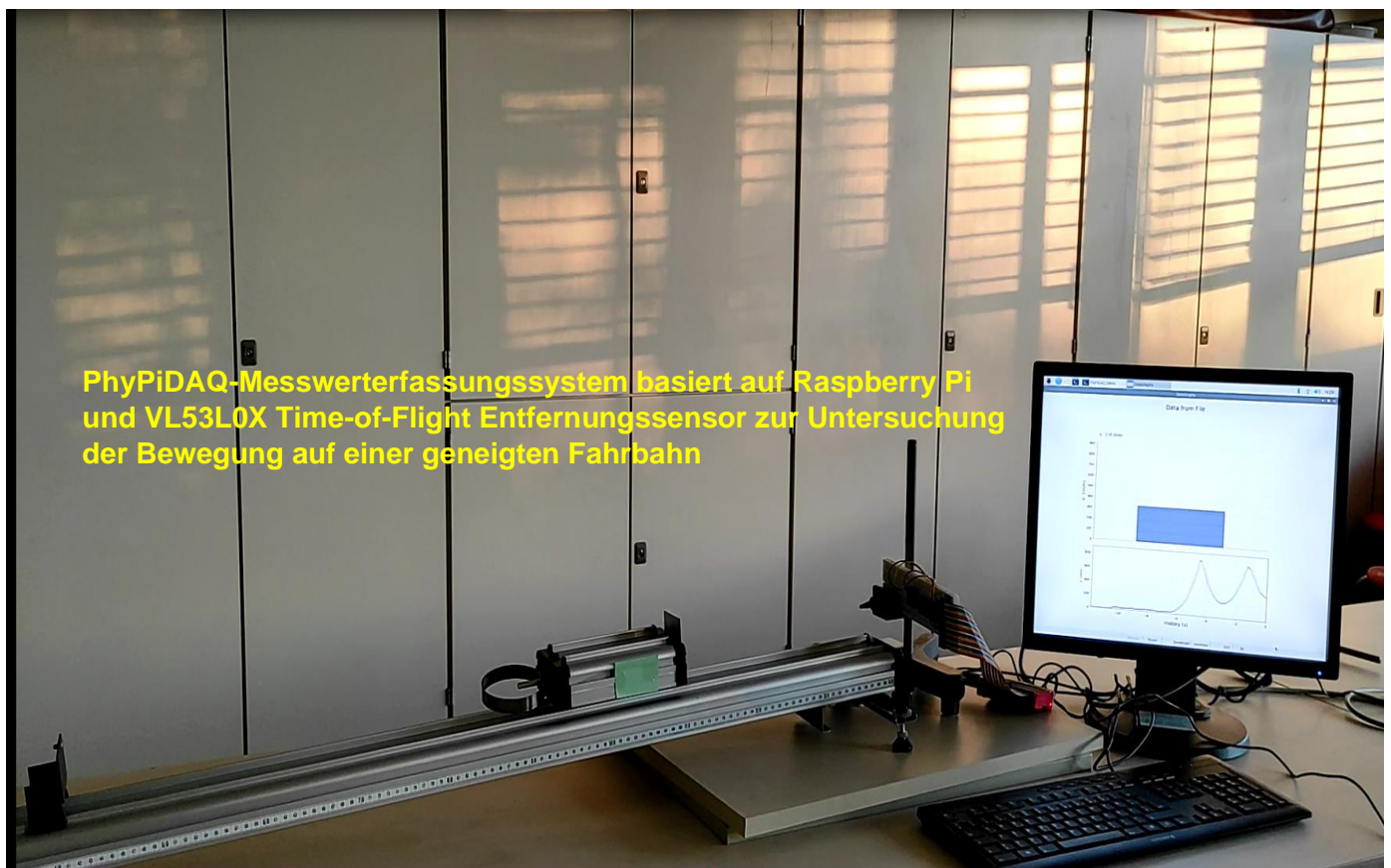
Abb.3 Fahrzeiten und Wegstrecken eines mit einer Stoßfeder vorgesehenen Experimentierwagen auf einer geneigten Fahrbahn gemessen mit dem PhyPiDAQ-Messwerterfassungssystem basiert auf Raspberry Pi und mit dem VL53L0X Time-of-Flight-Entfernungssensor. Zum Video
